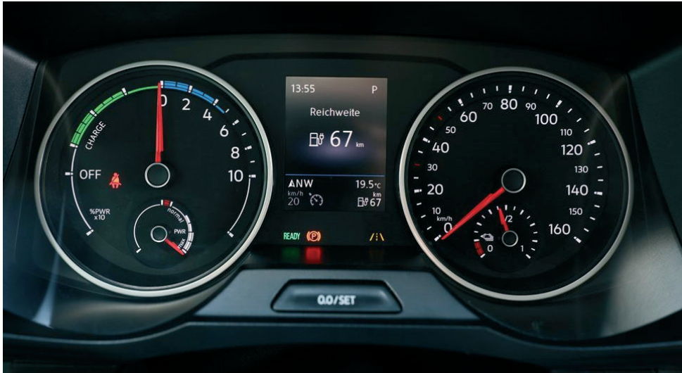
Rys. 10. Tablica wskaźników modelu Volkswagen e-Crafter z zegarem wskazującym stan naładowania baterii oraz niebieskim polem ekonomiczne wykorzystania energii i zielonym odzysku energii podczas hamowania silnikiem
