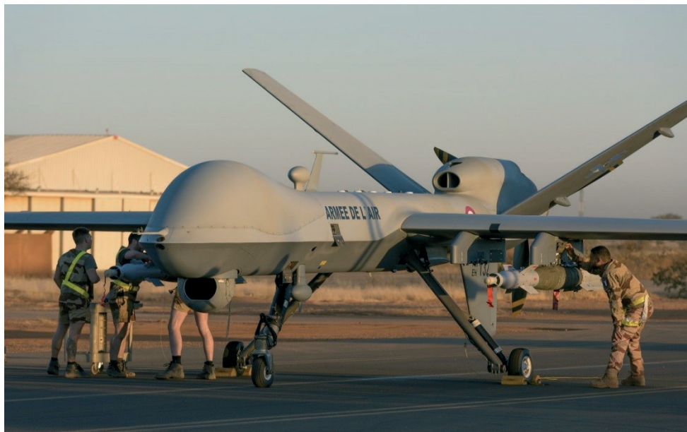
Rys. 2. Bezzałogowy Bojowy Aparat Latający MQ-9 Reaper , zdolny do przenoszenia i użycia czterech 250-kilogramowych bomb naprowadzanych na cel laserowo
